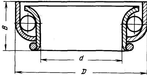
Шариковый радиально-упорный однорядный без сепаратора со штампованным кольцом
