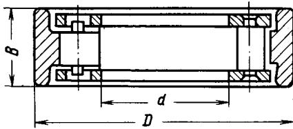
Роликовый радиальный с короткими цилиндрическими роликами без внутреннего кольца
