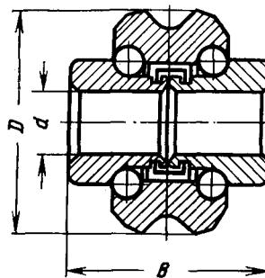
Шариковый радиально-упорный двухрядный со специальным наружным и двумя внутренними кольцами (без сепаратора)
