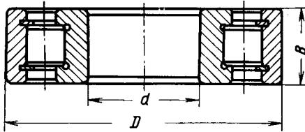
Роликовый радиальный с короткими цилиндрическими роликами без бортов на наружном кольце и с двумя шайбами без сепаратора
